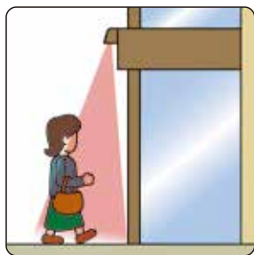
死角のない赤外線検知エリア、ドア直近まで確保 (24個のスポットのカーテンが2列)
